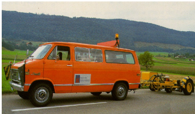
Fahrzeug mit Messanhänger
